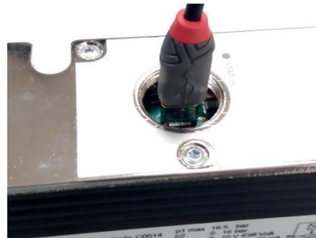
Diese Schnittstelle wird über VPTool mit einem Windows PC verbunden.
