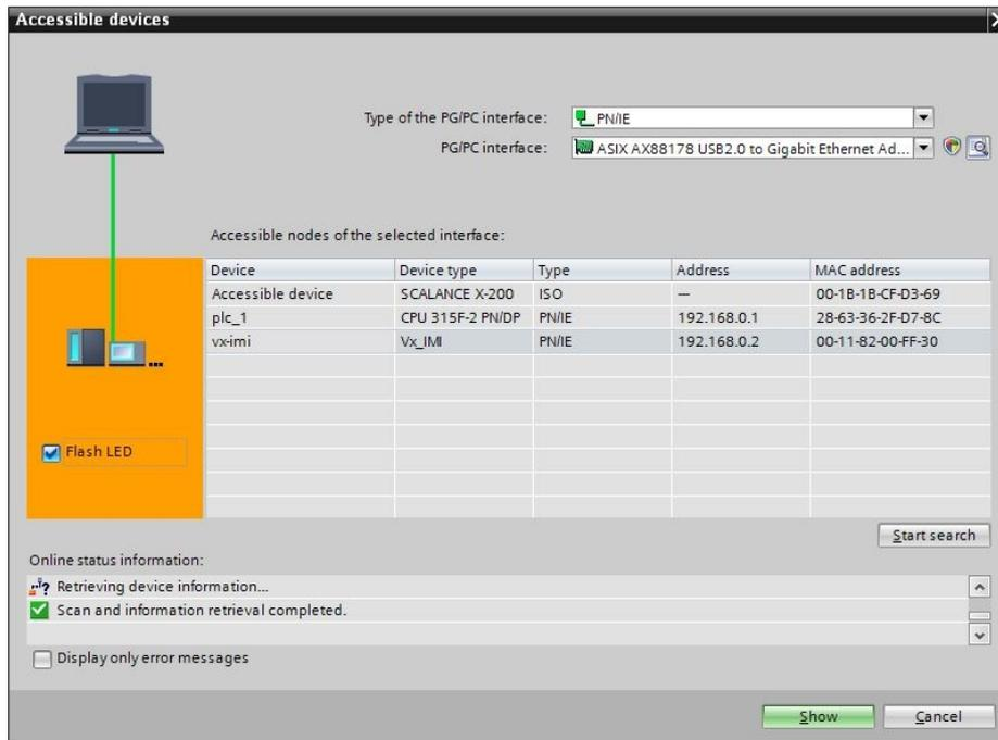
Mark an available valve island and enable checkbox “Flash LED”. This activates the LEDs: „BF“, „SF“, „VA“, „VB“ flashing in green color for 3 seconds
