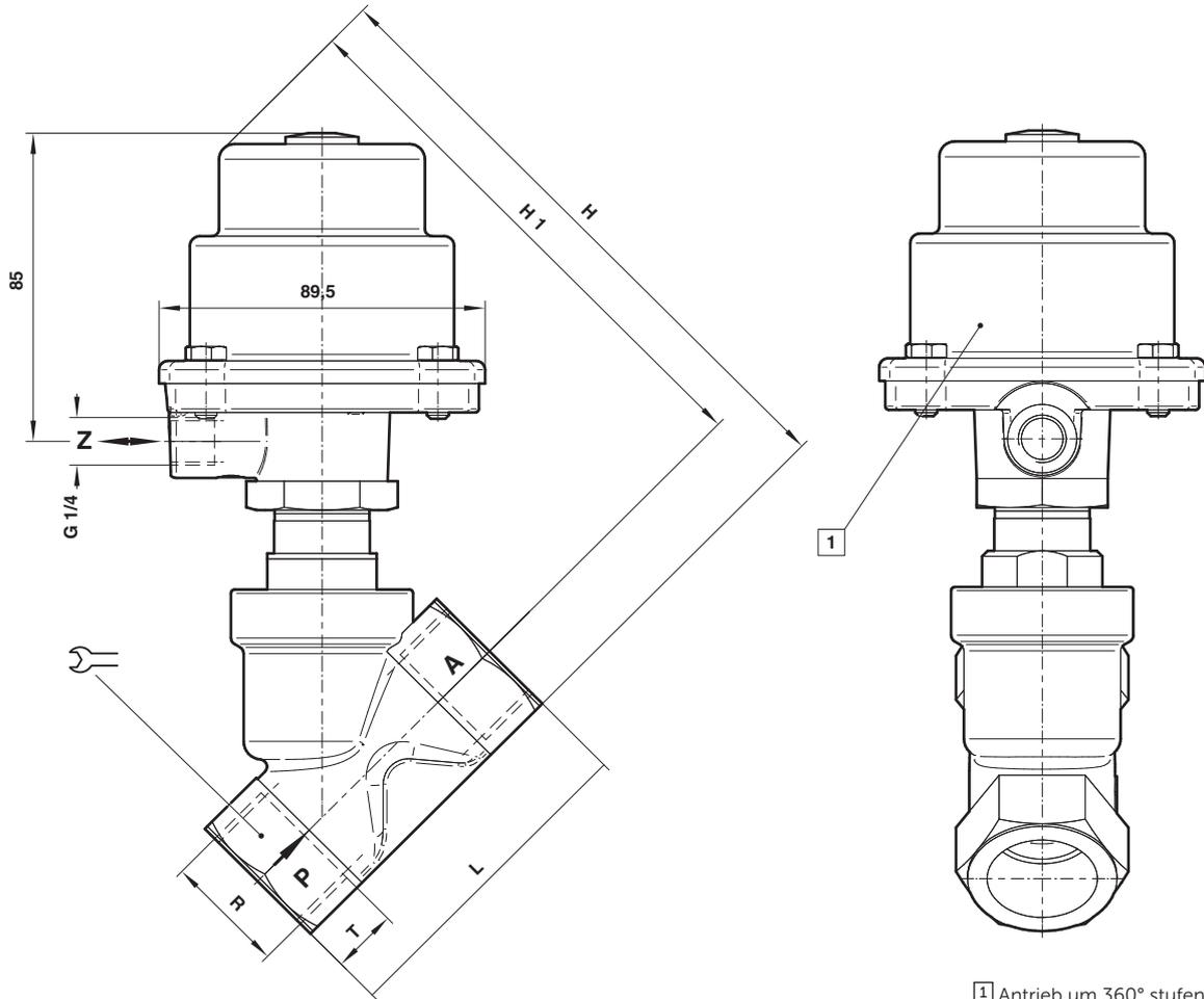
1 Antrieb um 360° stufenlos drehbar
