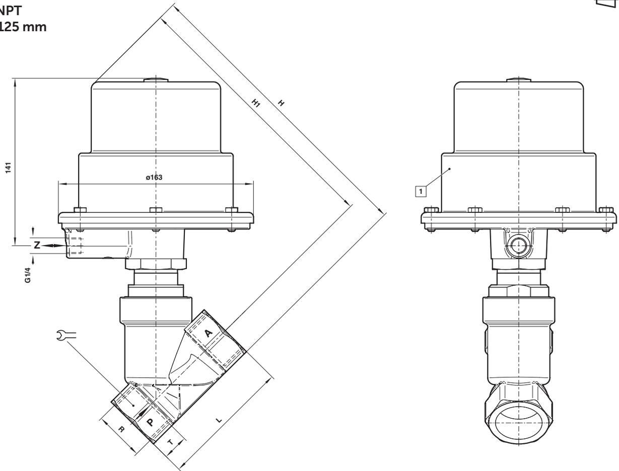
1 Antrieb um 360° stufenlos drehbar
