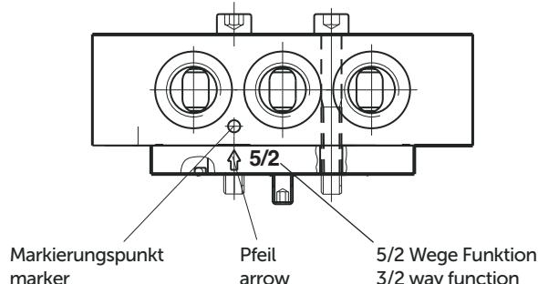
Die 3/2 bzw. 5/2 Wegefunktion des Ventils wird durch einfaches austauschen der beiden dem Ventil beigefügten Funktionsplatten realisiert. Hierbei ist darauf zu achten, daß der Markierungspunkt (Ventil) und der Pfeil (Platte) wie abgebildet übereinander stehen. Die Ventile werden werkseitig in der 5/2 Wege-Funktion ausgeliefert.
