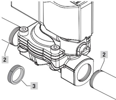
Gewinde der Rohrleitungen abdichten
