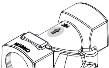
Kennzeichnung der Durchflussrichtung
