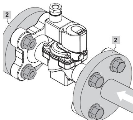
Rohrflansch mit Ventilflansch verbinden
