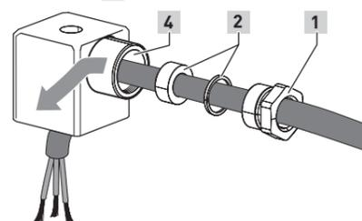
Kabel durch Gerätesteckdose führen
