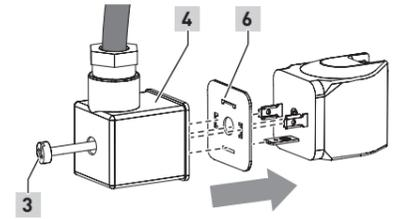
montierte Gerätesteckdose aufstecken
