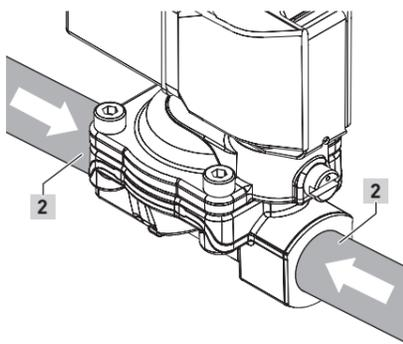
Rohrleitungen mit Ventil verbinden
