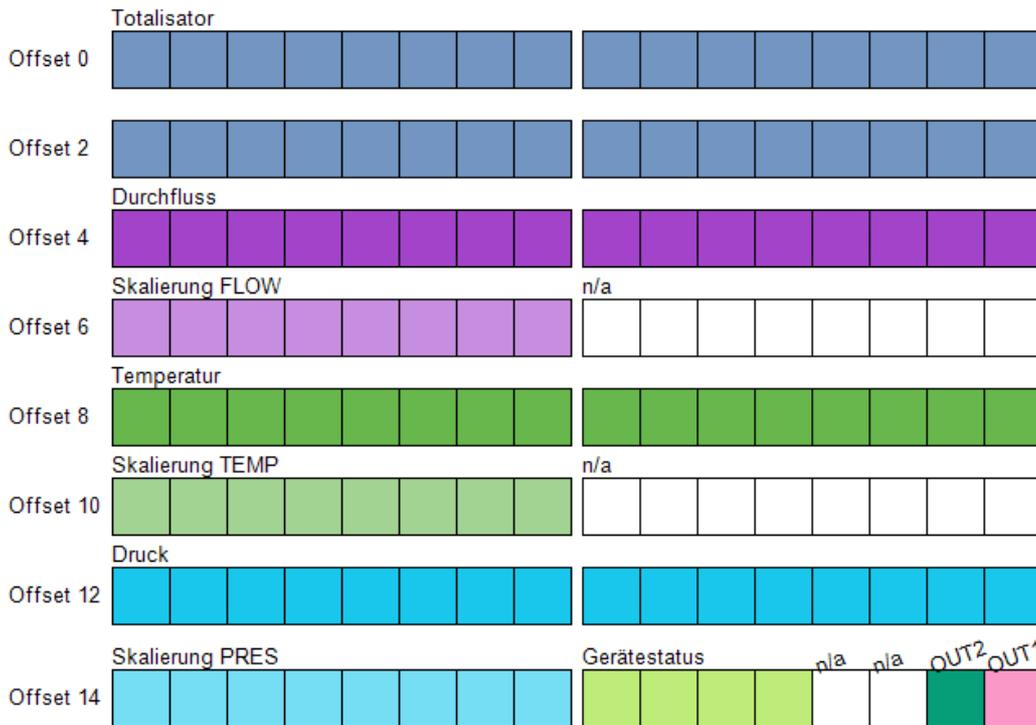
Skalierung FLOW: Ein SPS Profil-Funktionsblock errechnet den Strömungwert der Prozessdaten (ab WORD 4) in der profilierten Einheit [m<sup>3</sup>/h]
