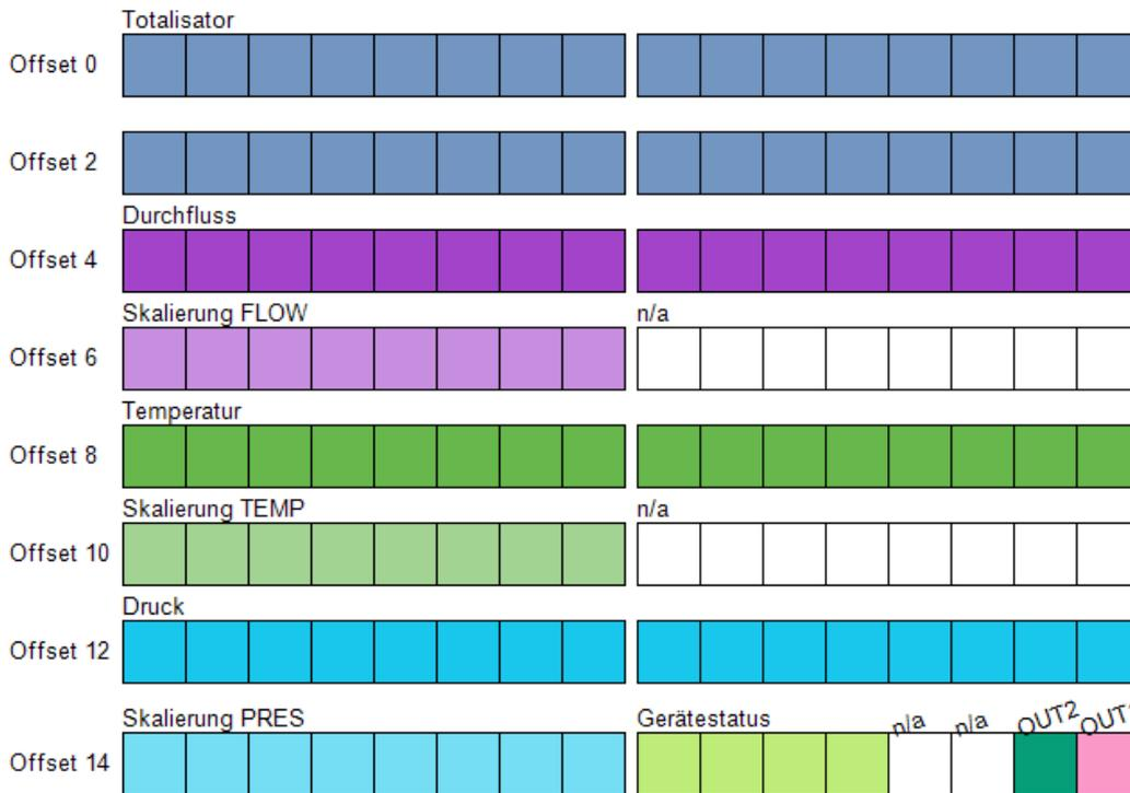
Skalierung FLOW: Ein SPS Profil-Funktionsblock errechnet den Strömungwert der Prozessdaten (ab WORD 4) in der profilierten Einheit [m3/h]
